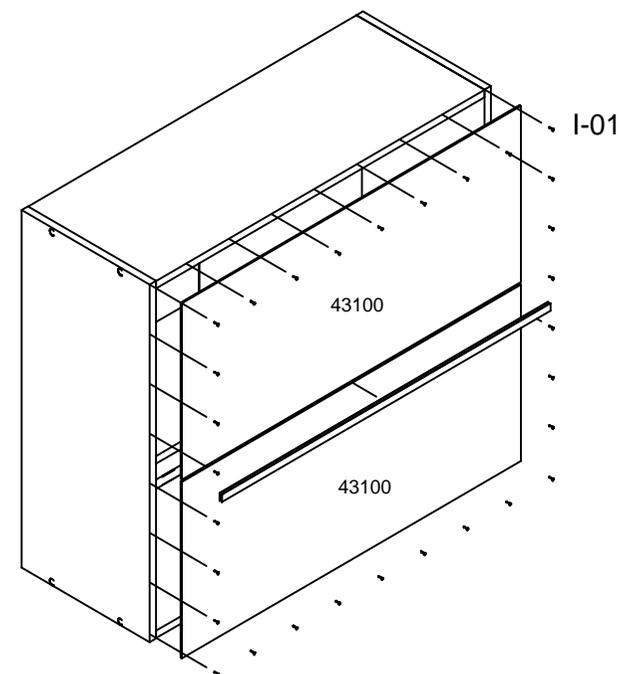
**Passo 3:** Usar dobradiças e parafusos **B-08** nas portas. Fixar o puxador com parafusos **B-08**.
