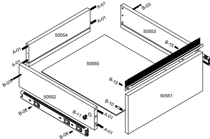
**Passo 3:** Fixar os trilhos telescópicos na divisão e lateral direita usando parafusos **B-08**.
