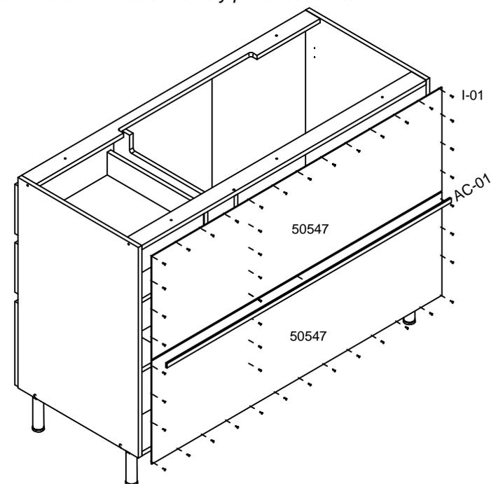
**Passo 5:** Usar dobradiças e calços para fixar as portas. Usar parafusos B-15 para fixar os puxadores.
